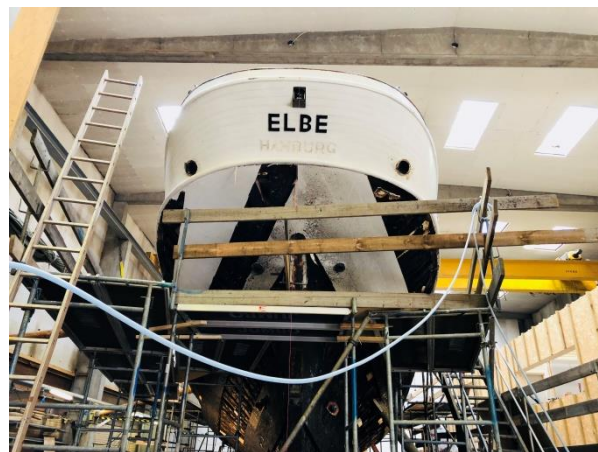
Gerüst am Achterschiff
